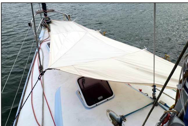
Par vent plus soutenu, disons à partir de 10 nœuds, le taud triangulaire se place plus ou moins horizontalement parallèlement au pont pour ne pas prendre trop de vent dans les rafales. Dans tous les cas, il empêche la cabine de devenir une fournaise en mettant son panneau de pont à l'ombre. Il met la plage avant à l'ombre pour la maintenir à la température du vent.
