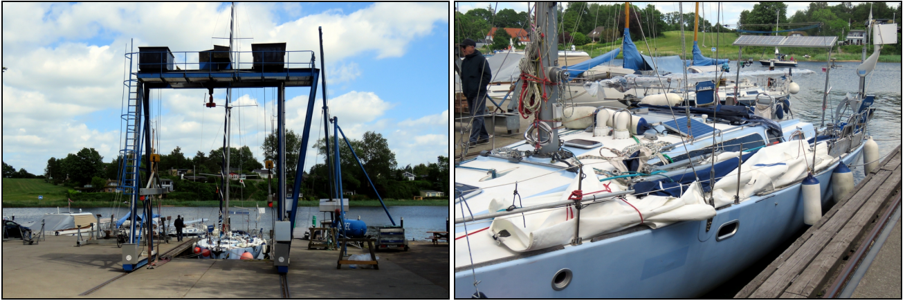
Préparatifs du démâtage : bôme, lazy bag, grand-voile, etc. tout est en vrac sur le pont. Bouts attachés au mât. Mât déconnecté des instruments, filières détendues.
