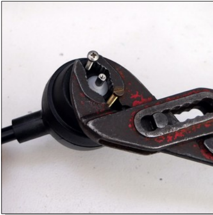
Vissez deux vis M4 dans deux trous opposés et utilisez une pince pour ouvrir la tête de l'instrument, sans endommager l'axe de la girouette
