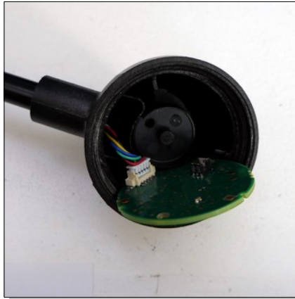
Déconnectez précautionneusement le circuit imprimé avec un petit tournevis
