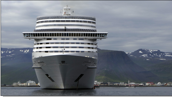
L'un des plus grands paquebots du monde, lancé en 2013 333 x 38 m, tirant d'eau 8.5 m, hauteur 59 m, 18 ponts 1 350 hommes d'équipage, 1 750 cabines, jusqu'à 4 000 passagers Moteur 54 000 CV (40 000 kW), vitesse 21 kts
