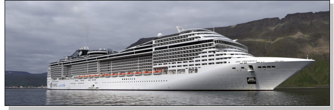
L'un des plus grands paquebots du monde, lancé en 2013 333 x 38 m, tirant d'eau 8.5 m, hauteur 59 m, 18 ponts 1 350 hommes d'équipage, 1 750 cabines, jusqu'à 4 000 passagers Moteur 54 000 CV (40 000 kW), vitesse 21 kts
