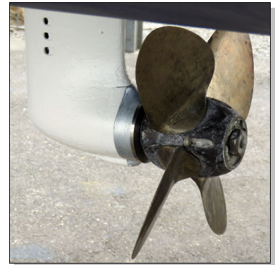
L'entretoise, entre l'anode et l'hélice
