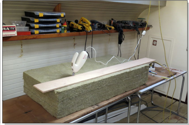
Découpage des matelas de laine de roche. Un couteau électrique est l'outil idéal. Vive Monlinex !
