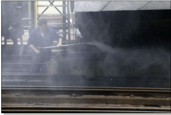
Nettoyage haute pression de la carène. Quel métier !
