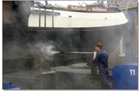
Nettoyage haute pression de la carène. Quel métier !
