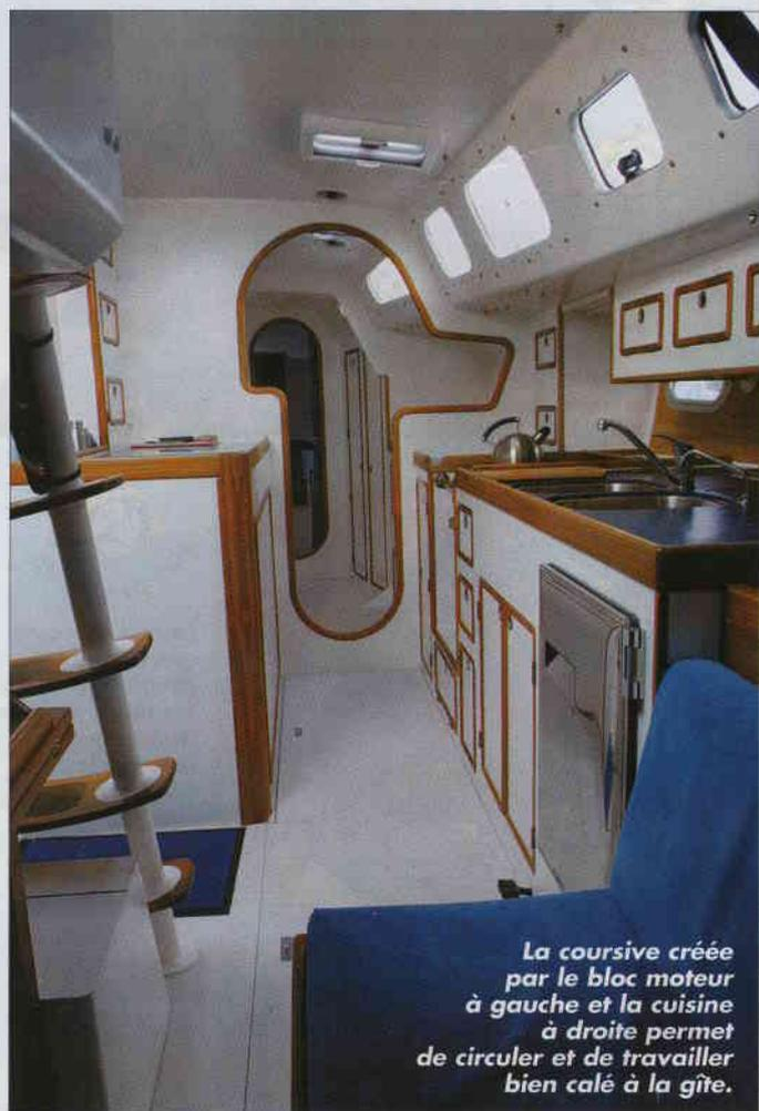
La coursive créée par le bloc moteur à gauche et la cuisine à droite permet de circuler et de travailler bien calé à la gîte.
