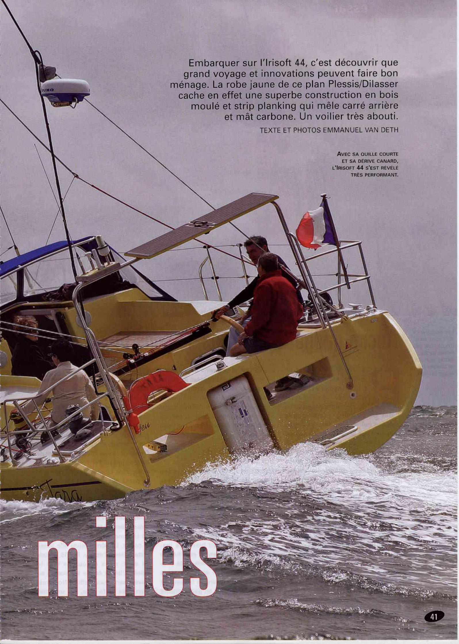
Embarquer sur l'Irisoft 44, c'est découvrir que grand voyage et innovations peuvent faire bon ménage. La robe jaune de ce plan Plessis/Dilasser cache en effet une superbe construction en bois moulé et strip planking qui mêle carré arrière et mât carbone. Un voilier très abouti.
